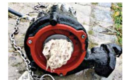
Feuchttücher im Abwasser führen zu schwerwiegenden Schäden an den Pumpen.
